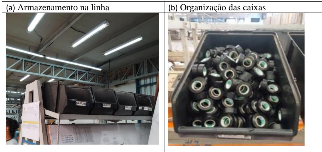
Figura 3- Abastecimento de fitas da linha de montagem antes do projeto Kanban
