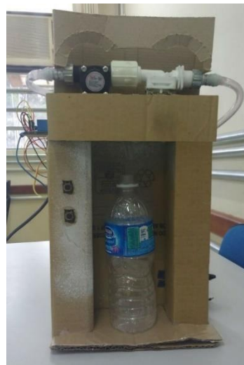
Figura 3 - Posicionamento do sensor Hall
