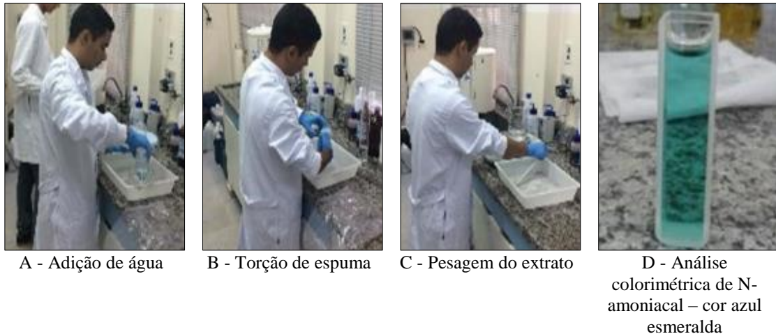
Figuras 2. Etapas do processo de extração do conteúdo líquido da espuma e determinação colorimétrica do N-volatilizado
