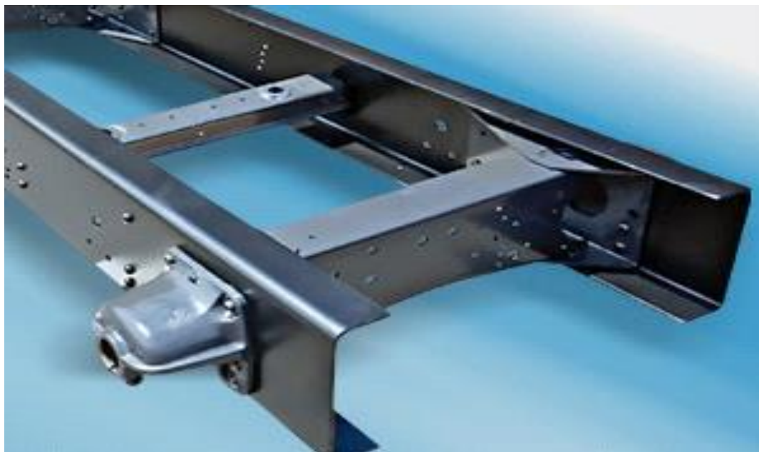
Figura 1: Detalhe de uma longarina de chassi urbano.
