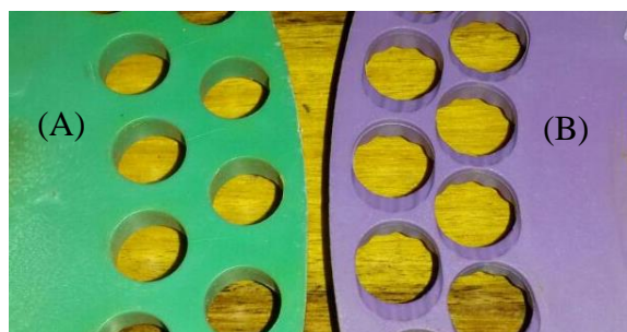
Figura 1. Disco horizontal convencional (A) e disco horizontal rampflow (B)
