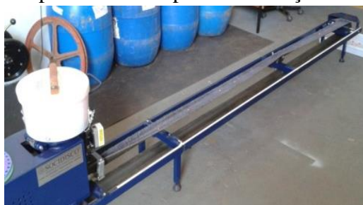
Figura 2. Esteira de plantabilidade para distribuição das sementes
